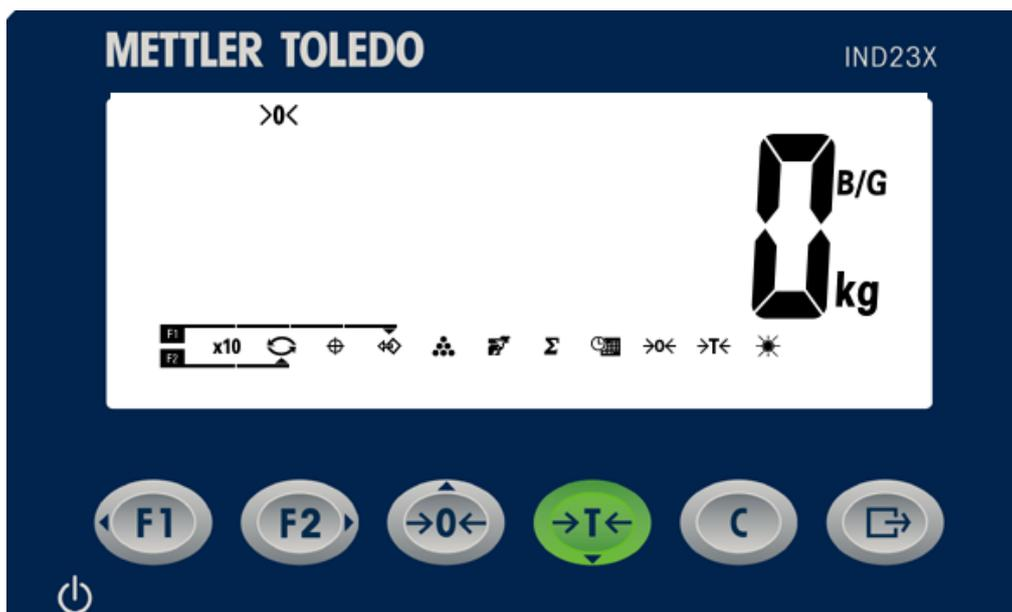
校正步骤：将秤台上物品清空，保持空载状态；
